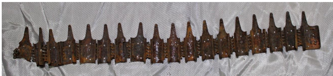
Патронная лента для 7,92-мм пулемётов MG-34 и MG-42
